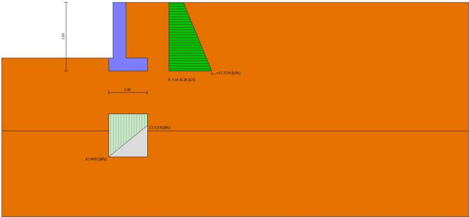
Fig. 5 - Diagramma delle pressioni (combinazione statica) (Combinazione n° 1)
